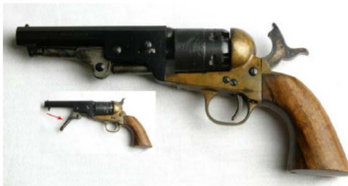
Abb.: Perkussionsvorderladerevolver (Pfeil = Ladepresse zum Laden der Trommel von vorne)
